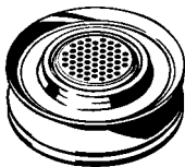
Die in den Dosierkapseladapter eingesetzte Dosierkapsel
