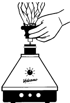
Den Ventilballon mit der Füllkammer verbinden
