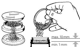
Llenar el Depósito
