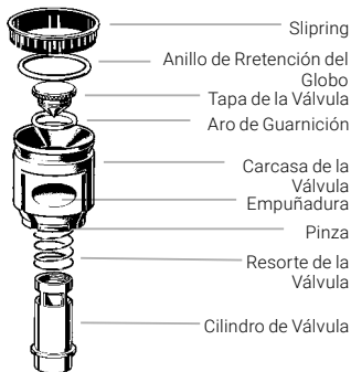
Desmontar la Pieza Interior del Depósito
